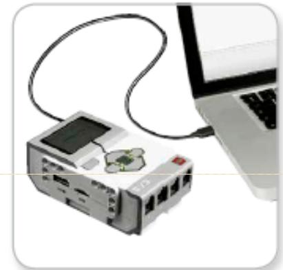
Connessione tramite cavo USB
